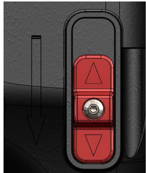
Position 2 : basse vitesse Pour une fraise d'un diamètre variant entre 30 et 40 mm.
